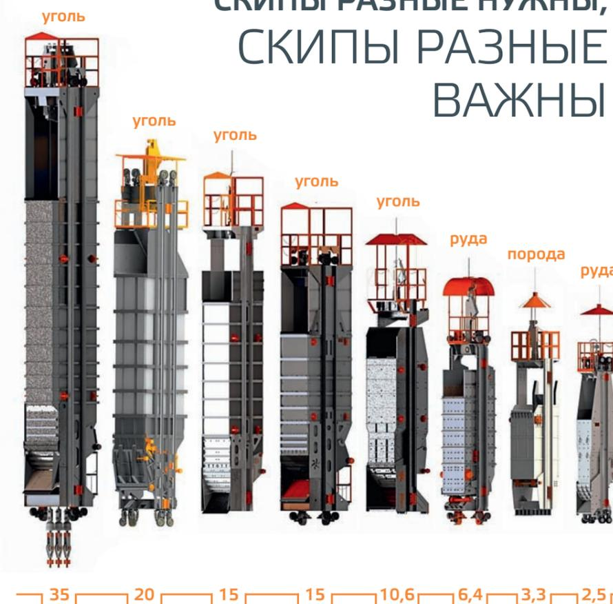
Геометрическая емкость кузова скупа, м<sup>3</sup>
