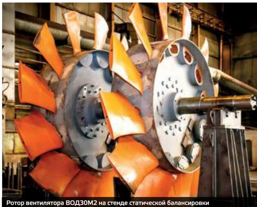
Ротор вентилятора ВОД30М2 на стенде статической балансировки
