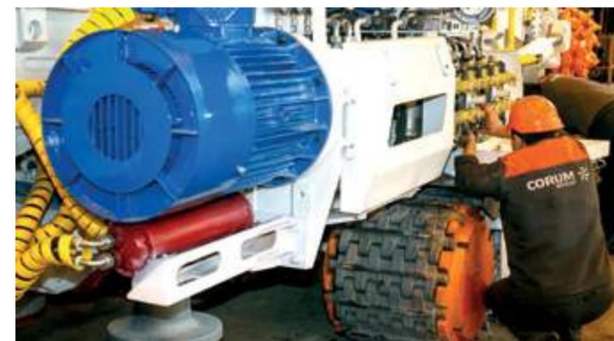
ного крепления, интегрированной в комбайны КПД. Такая установка применяется для механизации процесса анкерования в проходческих забоях и делает его безопасным.
