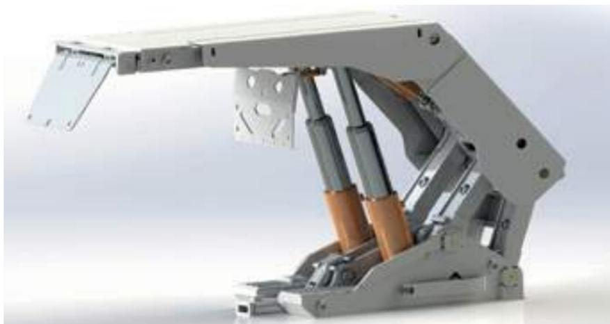
Для PGG машиностроители Согит готовят крепь новой конструкции – ZRP 15/35. Она предназначена для работы на пластах мощностью 1,8-3,5 м в условиях тяжелых кровель шахт Польши благодаря высокому рабочему сопротивлению – свыше 6000 кН. Заказчик будет использовать эту крепь на шахте Sośnica.
