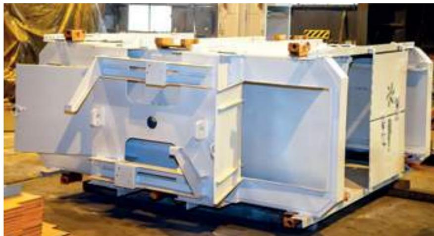
Конструкция верхних балок позволяет одновременно навешивать клеть и пружину ловителя парашюта, чтобы сократить время навески и упростить монтаж оборудования. Сварно-клепаный каркас обеспечивает повышенную прочность.
