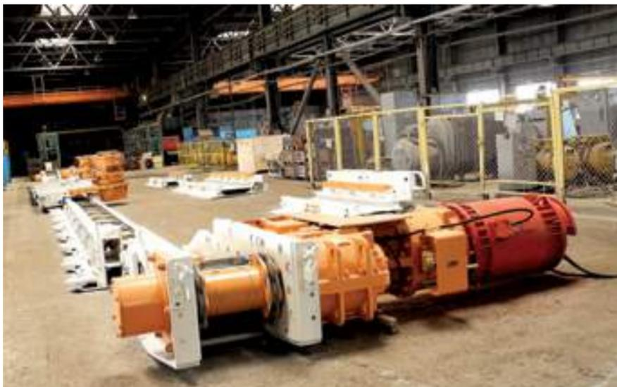
Для своих постоянных клиентов машиностроители Corum за период с начала 2018 года изготовили более десятка скребковых конвейеров и перегружателей как в серийном исполнении, так и с модернизацией, необходимой для конкретных горно-геологических условий.
