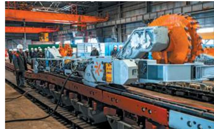
«Комбайн CLS450 изготавливался специально для отработки тонких и средних пластов с изменяющейся гипсометрией пласта от 1 до 2 м, характерные для Доброполья, – сообщила газета «Вестник шахтера». – Его освоение на шахте Добропольская проходило под руководством опытных специалистов службы главного механика предприятия и завода-производителя «Корум Свет шахтера». «Наши горняки успешно освоили эту технику завтрашнего дня, – отметил заместитель главного механика ШУ Добропольское Богдан Огоновский».
