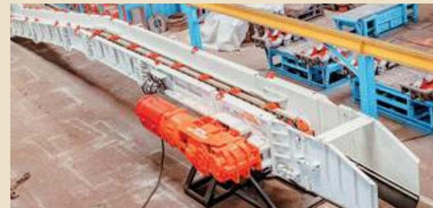
7 мая этого года на шахте «Обуховская» шахтный скребковый передвижной конвейер СПЦ230-71 производства «Корум Свет шахтера» перегрузил 2 млн тонн высокоабразивного антрацита и успешно завершил отработку шахтного поля.
